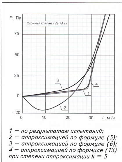
Рис. 2. Результаты испытаний и аппроксимация зависимости «давление — расход воздуха» для оконного клапана «VentAir»
